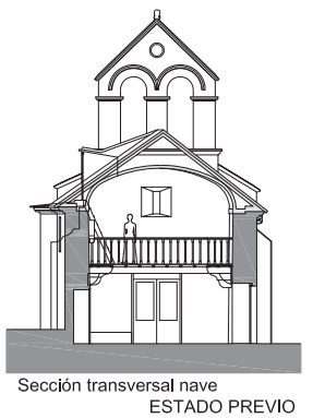
Patoloxías: Procederese á retirada da saída ao campanario e canalóns de fibrocemento, así como ao derribo e substitución da falsa bóveda da nave
